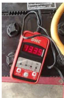
แบตเตอรี่หมายเลข 1 แรงดัน 13.35 VDC ค่าCCA = 384
