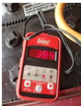
แบตเตอรี่หมายเลข 1 แรงดัน 13.35 VDC ค่าCCA = 384
