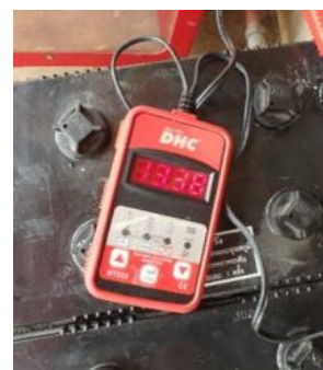
แบตเตอรี่หมายเลข 2 แรงดัน 13.38 VDC ค่าCCA = 451
