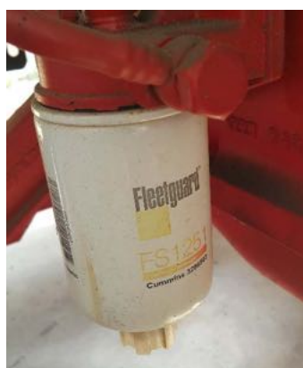
ไส้กรองน้ำมันเชื้อเพลิงเดิม
