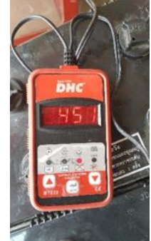
แบตเตอรี่หมายเลข 2 แรงดัน 13.38 VDC ค่าCCA = 451
