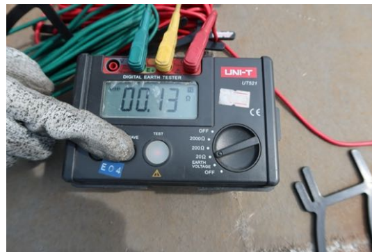
ค่าการต้านทานลงดิน 0.13 โอห์ม
