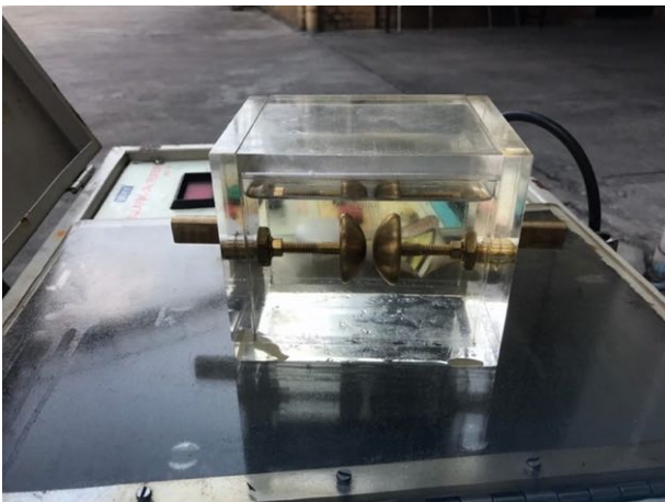
ภาพทดสอบน้ำมันหม้อแปลง
