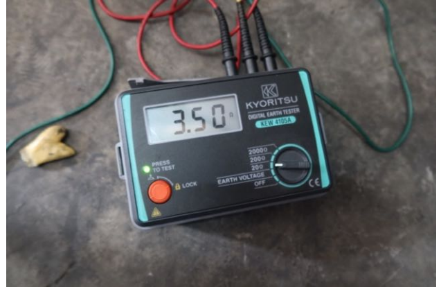
ภาพการตรวจสอบค่าความต้านทานการต่อลงดิน
