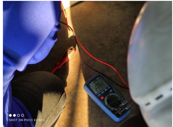
ภาพตรวจสอบค่าความจุของตัวเก็บประจุ
